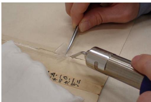
小型温風器を用いたテープの除去作業（使用機器：白光(株)製 FR-810B)
