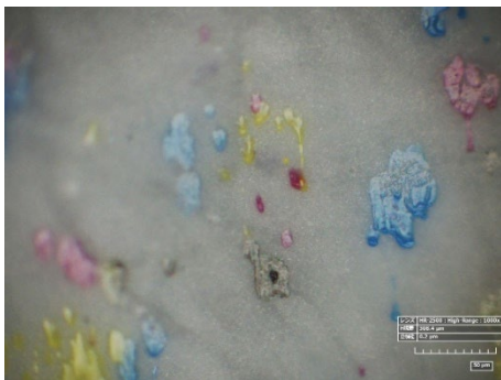
参考：塗工紙（コート紙チラシ） 顕微鏡写真
