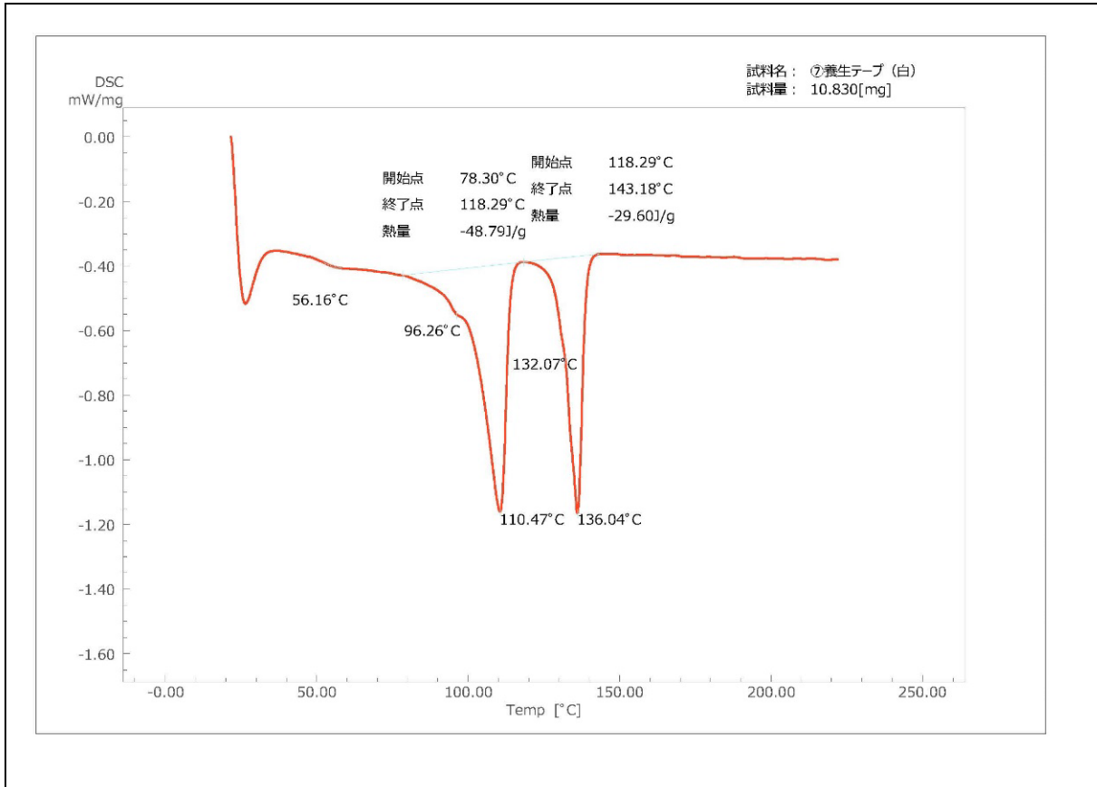
図7 ⑦養生テープ (白) / 粘着剤推定物質: ゴム系+炭酸カルシウム?
